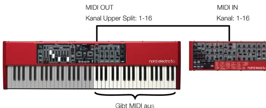
*MIDI-Verkabelung:* Verbinden Sie den MIDI OUT des Nord Electro 5 über ein 5-poliges MIDI-Kabel mit dem MIDI IN des externen Sound-Expanders.
