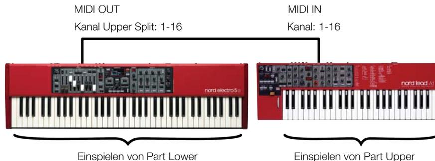
**MIDI-Verkabelung:** Verbinden Sie den MIDI IN des Nord Electro 5 über ein 5-poliges MIDI-Kabel mit dem MIDI OUT des externen Keyboards.
