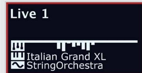
Bei Live-Programmen sieht die Anzeige ähnlich aus, allerdings wird hier je nach ausgewähltem Live-Programm die Bezeichnung „Live“ gefolgt von der Programmnummer eingeblendet. Um ein Live-Programm auszuwählen, drücken Sie in der Programm-Sektion eine der Tasten Live 1 – 3.
