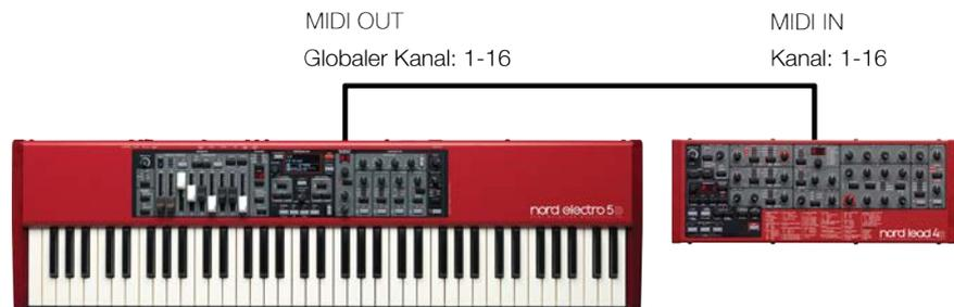
*MIDI-Verkabelung:* Verbinden Sie den MIDI OUT des Nord Electro 5 über ein 5-poliges MIDI-Kabel mit dem MIDI IN des externen Sound-Expanders.
