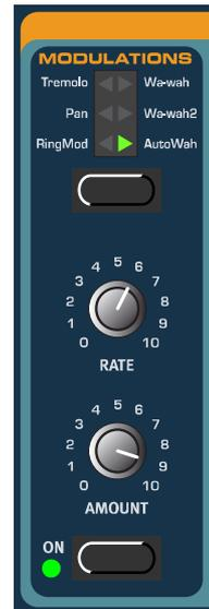
サイン波のピッチは[RATE]ノブで、変調の深さは[AMOUNT]ノブで調節します。
