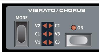
**B3** - L'originale chorus e vibrato scanner dell'organo tonewheel consiste in una linea di ritardo in combinazione con uno scanner rotante. Per l'effetto Vibrato viene applicato al segnale lo spostamento di fase. Per il Chorus, un segnale modulato in fase è aggiunto al segnale originale. Sono disponibili tre diversi tipi di Chorus (C1-C3) e tre diversi tipi di Vibrato (V1-V3).
