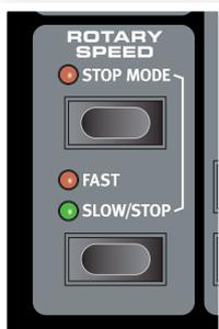
Per arrestare i rotori, premere il pulsante **Stop Mode** per attivare la modalità di arresto e poi il pulsante Slow/Stop (questo non disattiva la simulazione Rotary Speaker, ma ferma solo i rotori). Quando si preme il pulsante Slow/Stop nuovamente, i rotori accelereranno alla velocità **Fast**. Questa funzionalità, simula il comportamento di un vecchio rotary speaker originale.
