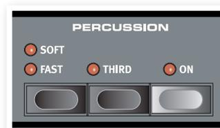
L'effetto Percussion è un effetto "single-triggered" non legato. Con "single-triggered" si intende che la percussione è presente solo quando si suonano i tasti e nessuna altra nota sta suonando. In altre parole, se si suona una nota o un accordo e poi si aggiungono altre note senza rilasciare le precedenti, non ci sarà alcun effetto Percussion nelle note appena suonate. Bisogna rilasciare tutti i tasti per poter suonare con l'effetto Percussion.
