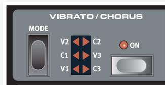
**B3** – Bei dem Chorus- und Vibrato-Scanner der originalen Tonewheel-Orgel handelt es sich um eine Delay-Line mit Abgriffen in Kombination mit einem rotierenden Scanner. Für den Vibrato-Effekt wird die Phase des Signals verschoben. Für den Chorus-Effekt wird dem Signal zudem ein phasenmoduliertes Signal zugemischt. Es stehen jeweils drei unterschiedliche Chorus (C1-C3) - und Vibrato-Typen (V1-V3) zur Verfügung.
