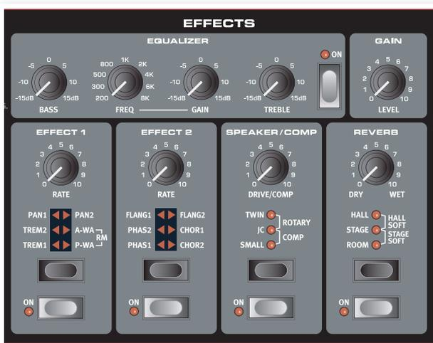
Über die Effects-Sektion des Nord Electros 3 können die Piano-Sounds nachbearbeitet werden. Diese Sektion ist voll programmierbar, so dass Sie individuelle Effekte für jedes Programm anlegen können.
