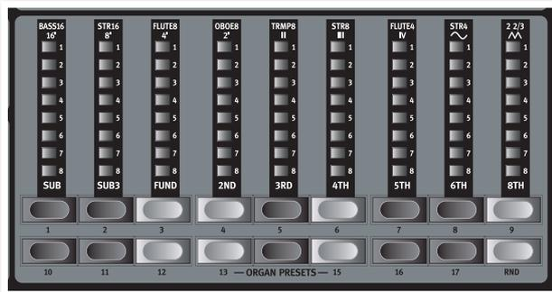
Die Drawbars des Nord Electro 3 werden über Tasten und LED-Balken nachempfunden. Der Vorteil: Wenn Sie das Programm wechseln, werden die Drawbar-Einstellungen sofort über die LEDs hergestellt.
