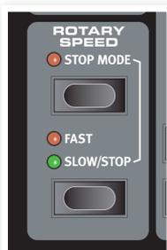
Um die Rotoren anzuhalten, aktivieren Sie zuerst über die Taste **Stop Mode** den Stop-Modus und drücken dann die Slow/Stop-Taste (die Rotor-Effekt-Simulation wird dadurch nicht deaktiviert - nur die Rotoren werden angehalten). Wenn Sie die Slow/Stop-Taste erneut drücken, werden die Rotoren wieder auf die Geschwindigkeitseinstellung **Fast** beschleunigt. Diese Funktion simuliert ein älteres Leslie ohne regelbare Geschwindigkeit.
