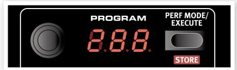
ダイヤルはロータリー・エンコーダーですので何回転でも回せます。パラメーターの値が上限値に達した場合、ダイヤルを時計回りに回しても何も変化しません。同様に下限に達した場合もダイヤルを反時計回りに回しても何も変化しません。
