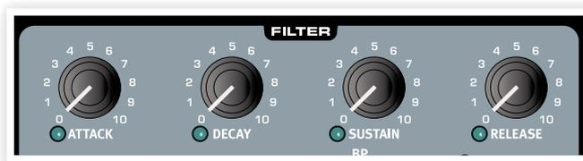
フィルター・エンベロープは、キーボードを弾いた瞬間から手が離れるまでの間、フィルターのカットオフ・フリクエンス ([FREQ] パラメーター) の時間的な変化をコントロールするセクションです。
