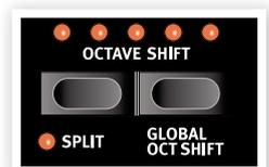
ボタンの上に並んでいるLEDのうち、センターのLEDが点灯している場合は、トランスポートしていない状態を示します。
