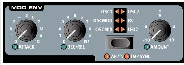
モジュレーション・エンベロープは、アタック、ディケイ/リリース、アマウントの各コントロールを備えたモジュレーション用エンベロープで、Nord Lead 4の様々なパラメーターをモジュレーションします。また、通常はフィルターやアンプのエンベロープと同様、キーボードを弾いた瞬間にスタートします。モジュレーション・エンベロープの出力は〔AMOUNT〕ノブで調整でき、左側に回すと反転出力も行えます。
