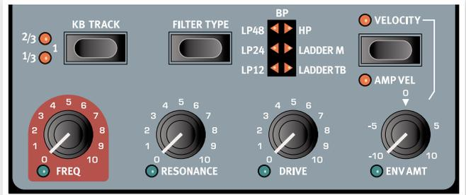
フィルターはNord Lead 4の音色を決定づける最も重要なセクションの1つです。オシレーターが生成した倍音を豊富に含んだ音は、このフィルター・セクションで加工され、フィルター自体もその他のセクションによってモジュレーションを受けることにより、様々な音色に変化させることができます。Nord Lead 4のフィルター・セクションは、トラディショナルなローパス、バンドパス、ハイパスの各フィルターの他に、非常に切れ味の鋭い48dBローパス・フィルターやビンテージ・シンセサイザーのフィルター回路を忠実に再現した「Ladder M」と「Ladder TB」フィルターも内蔵しています。
