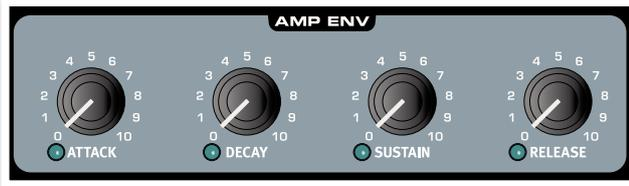
アンプ・エンベロープは音量の時間的な変化を作り出すセクションです。具体的にはエンベロープ・ジェネレーターでアンプをモジュレーションすることにより、音量の時間的な変化を作り出しています。この音量の時間的な変化というのは、私たちが普段から音を認識するのに非常に重要な要素の1つとなっています。アンプ・エンベロープの設定で、「ソフトな音」や「ハードな音」、「短い音」や「長くずっと鳴っている音」というように様々な音色を作り出せます。
