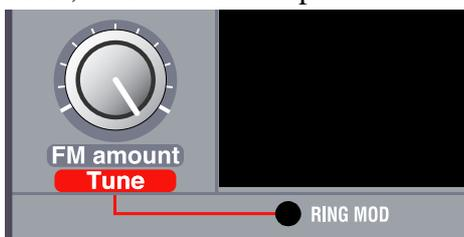
*Quand Ring Modulation est activée, le potentiomètre FM Amount fonctionne comme un réglage Tune, avec un intervalle approximatif d'une octave. Pour régler une hauteur "normale", éteignez Ring Modulation et jouez une note, puis réactivez Ring Modulation, jouez la même note et ajustez le potentiomètre Tune jusqu'à ce que la hauteur soit la même. Veuillez noter que la hauteur changera encore si vous changez le timbre en ajustant le potentiomètre Semitones.*
