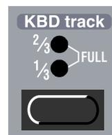
La raison pour laquelle on utilise l'interrupteur Keyboard Track est liée aux phénomènes acoustiques. Si vous augmentez la hauteur d'une forme d'onde, les harmoniques verront leur fréquence augmenter naturellement. Si la fréquence du filtrage est constante, la couleur du son changera selon les notes jouées et pourra paraître imprécis dans les aigus. Pour éviter cet effet, utilisez KBD Track (ou pondération du clavier).
