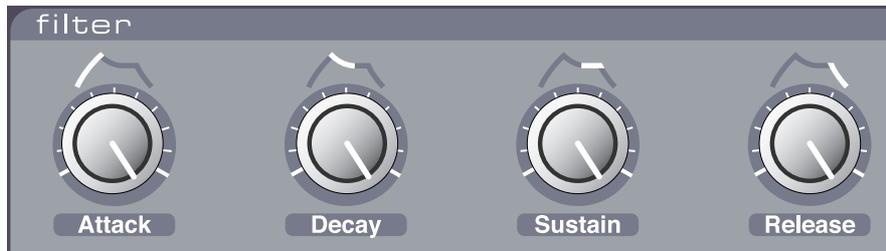
Ce sont les paramètres pour l'enveloppe de filtre, leur fonctionnement est identique à l'enveloppe de l'amplificateur voir p44
