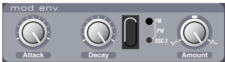
Il s'agit d'un type simple d'enveloppe contenant seulement les contrôles Attack, Decay et Amount. Il y a une différence par rapport au fonctionnement des autres enveloppes c'est qu'il partira de 0 chaque fois que vous appuierez sur une nouvelle note.
