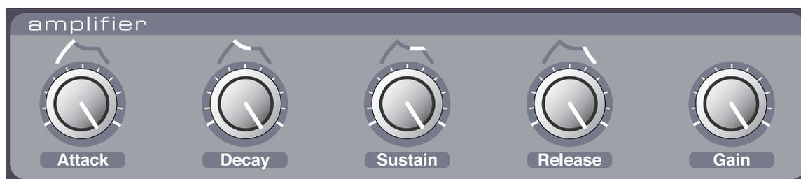
La section Amplifier sert à ajuster le volume du son. L'Amplifier Enveloppe (enveloppe d'amplification) se compose des paramètres Attack, Decay, Sustain et Release. L'enveloppe d'amplitude est utilisée pour donner sa forme de base au son (doux, lent, court, long, etc.). Pour une introduction aux enveloppes, voir page 86.
