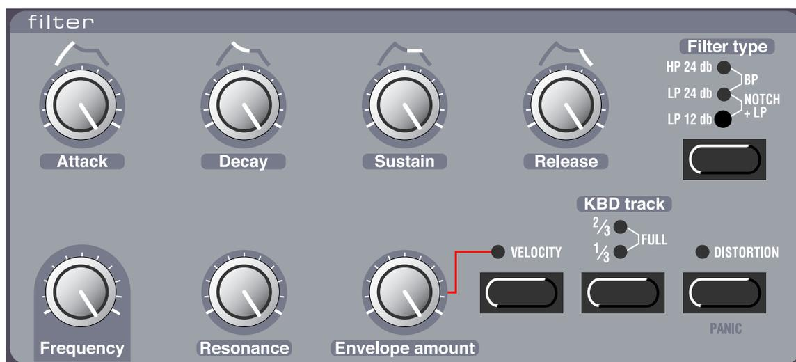
La section Filter est la plus importante pour former le timbre global du son. Le filtre du Nord Lead peut être de divers types. Il dispose des contrôles standards de Résonance et de Fréquence générale. Les paramètres Attack, Decay, Sustain et Release forment l'Enveloppe de Filtre. Ceux-ci, avec le potentiomètre Envelope
