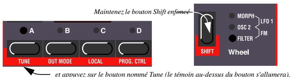
2. Utilisez les boutons Program Haut/Bas situés à gauche de l'affichage pour modifier la valeur. 00 est le réglage normal 440 Hz. Des fréquences inférieures sont indiquées par un point à droite du chiffre et des valeurs supérieures sont indiquées sans point. Les valeurs sont en centièmes (centième de demi-ton).
