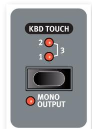
Quand toutes les DEL sont éteintes, c'est la courbe de réponse par défaut qui est active. Un réglage Kbd Touch de 1 rend un peu plus facile l'obtention de la dynamique maximale, un réglage de 2 encore plus facile et le troisième réglage est la courbe de réponse correspondant au clavier le plus léger.
