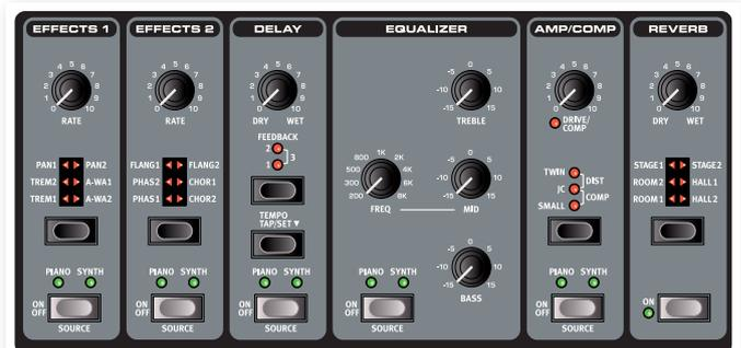
La sezione effetti del Nord Piano 2 può essere utilizzata per processare il suono del piano e del sample synth. È programmabile e può essere impostata individualmente per ciascun programma. Alcuni degli effetti sono strutturati con ingresso ed uscita mono, altri con ingresso ed uscita stereo. La configurazione dei canali verrà spiegata nella descrizione di ciascun effetto.
