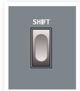
*Se si tiene premuto Shift mentre si gira un knob, sarà possibile visualizzare sul display il valore del parametro senza modificarlo.*
