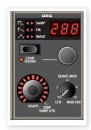
Ad esempio, la categoria Analog offre diverse forme d'onda dotate o meno di hard sync. In ogni caso, il controllo Shape andrà a gestire un singolo parametro essenziale, quale l'ampiezza della pulsazione o il sync della frequenza di oscillazione. Il parametro Shape può essere modulato dall'LFO o dall'inviluppo di modulazione per creare suoni dinamici. Il knob Shape può anche essere controllato dal Morph Assign.
