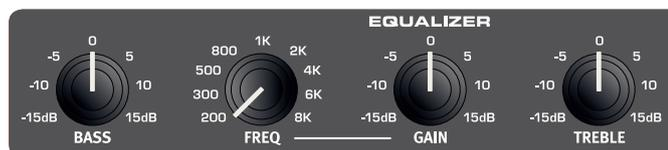
Dieser 3-Band-Equalizer bietet Regler für Bass, Mitten und Höhen. Die **BASS**-Frequenz liegt bei 100 Hz, die **HÖHEN** bei 4 kHz und die über den **FREQ**-Regler steuerbaren **MITTEN** je nach Einstellung zwischen 200 Hz und 8 kHz. Der Hub kann auf Werte zwischen +/- 15 dB eingestellt werden.
