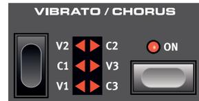
Die originalen Chorus- und Vibrato-Scanner von Tonewheel-Organen bestehen aus einer modulierten Delay-Line und einem rotierenden Scanner. Der Vibrato-Effekt wird durch eine Verschiebung der Signalphase erzeugt. Für den Chorus-Effekt wird dem Signal zusätzlich ein phasenmoduliertes Signal zugemischt.
